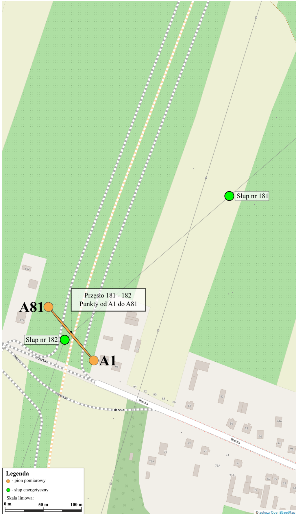
Rys. 1. Lokalizacja pionów pomiarowych dla przęsła nr 181-182 (Linia 400 kV Kozienice – Ostrowiec).
