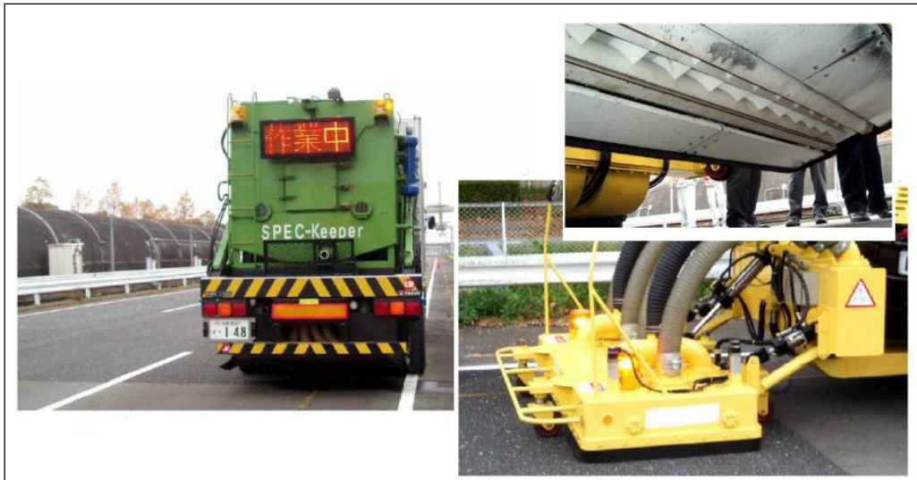
Rysunek 4 Sprzęt wykorzystywany przy oczyszczaniu nawierzchni z asfaltu porowatego (Źródło: Zastosowanie nowoczesnych technologii w konstrukcjach drogowych, Zakopane 15–17.09.2010 r.)
